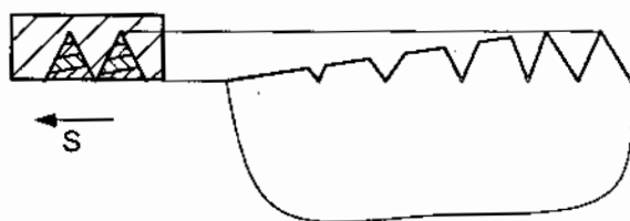
Hình 10.6: Sơ đồ tiện ren bằng dao răng lược.
