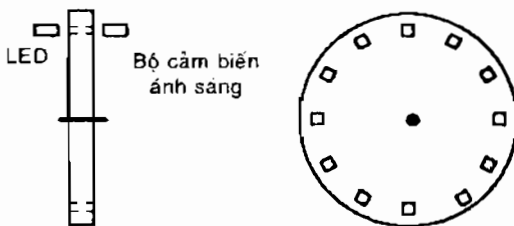
Hình 2.8. Dạng cơ bản của bộ mã hóa gia số.
