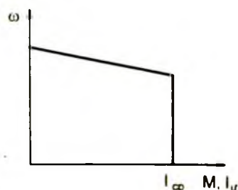
Hình 4 - 15. Dạng đặc tính của hệ điều chỉnh độc lập các tọa độ kiểu nối tiếp
