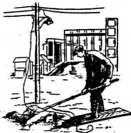
Hình 3.1c Dùng gậy gạt dây điện ra khỏi người bị nạn
