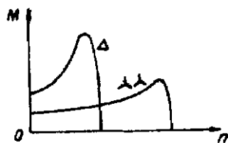
Hình 19-10. Đồ thị mômen M = f(n) của động cơ điện hai tốc độ có sơ đồ đấu dây như ở hình 19-8
