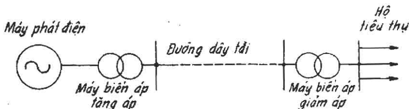
Hình 1-1. Sơ đồ mang truyền tải điện đơn giản
