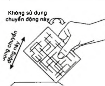
Hình 2-9. Phương pháp tháo các linh kiện khỏi bản mạch in
