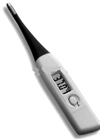
Hình 3-6 : Ứng dụng nhiệt điện trở để chế tạo nhiệt kế điện tử
