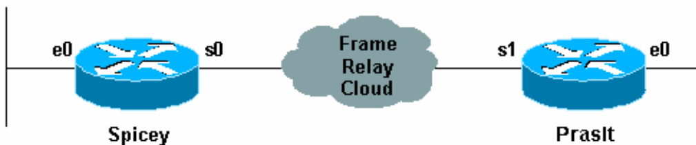
Hình 3.34: Mô hình kết nối Frame Relay cơ bản
